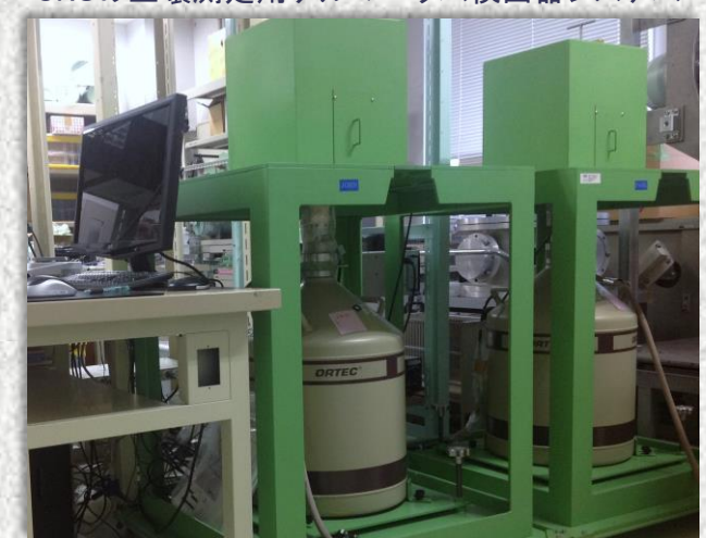
CNSの土壌測定用ゲルマニウム検出器システム
