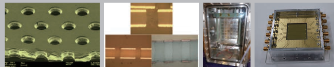
(写真左から) CERN GEM、日本製 GEM の断面図、アクティブ標的、ダイヤモンド検出器
